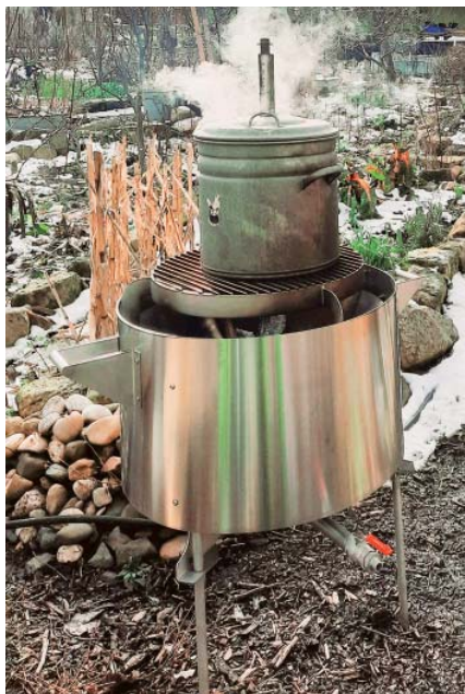
Bei der Herstellung von Pflanzenkohle im Kontiki kann die „Abwärme“ zum Dämpfen von Aussaaterde nachgenutzt werden.
